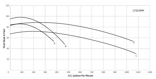
A. 65/250 (Ø 225mm) - 7.5 HP S.F. 1.25 B. 65/250 (Ø 240mm) - 10 HP S.F. 1.25 C. 100/250 (Ø 220mm) - 15 HP S.F. 1.25 D. 100/250 (Ø 240mm) - 20 HP S.F. 1.25
