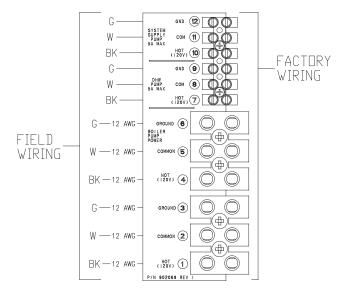
Fig. 28: XTherm Cascade Master-Pumps
