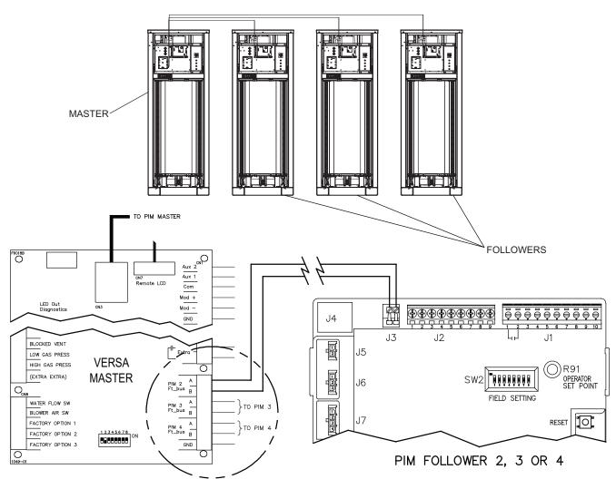
Fig. 27: XTherm Cascade System Wiring
